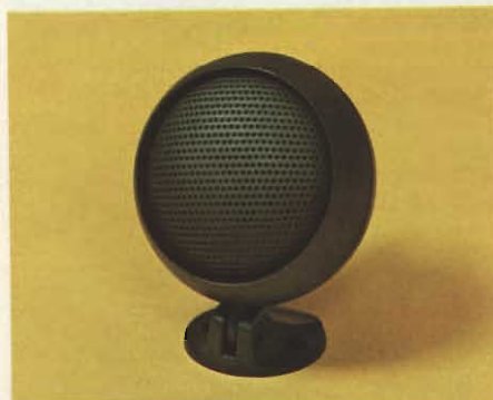
Custodia a sfera con altoparlante "BANDRIDGE" In ABS nero lucido Altoparlante sferico a doppio cono pneumatico ø 100 Potenza d'uscita: 10 W RMS Risposta di frequenza: 180÷16.000 Hz Impedenza: 4 Ω KA/1555-00
