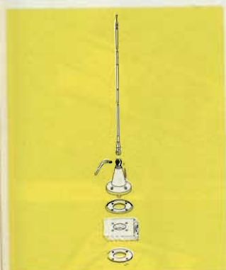
Antenna omnidirezionale 27 MHz Fissaggio: su imbarcazioni mediante base in materiale isolante Inclinazione: variabile Elemento ricevente: fibra di vetro Lunghezza stilo: 1100 Impedenza: 52 Ω NT/0902-00
