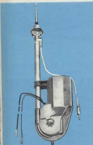
Antenna elettrica semi-automatica Fissaggio: su carrozzeria Sezioni: 4 Lunghezza stili: 970 Parte da incassare: 310 Lunghezza cavo: 1.150 Dotazione: interruttore Inclinazione: 0°÷43° Alimentazione: 12 V KT/2065-00
