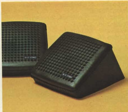
Custodia con altoparlante "BANDRIDGE" In ABS nero Potenza d'uscita: 6 W RMS Risposta di frequenza: 120÷10.000 Hz Frequenza di risonanza: 150 Hz Impedenza: 4 Ω KA/1900-00
