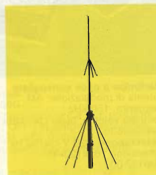
Antenna GROUND-PLANE 27 MHz Montaggio: su palo da 1 1/4" Lunghezza radiatore: 2700 Lunghezza radiali: 2580 Ingombro totale: 3880 Altezza totale: 4700 Potenza max applicabile: 1kW RF Impedenza: 52 Ω Materiale: alluminio NT/1680-01
