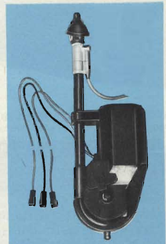
Antenna elettrica automatica Fissaggio: su carrozzeria Sezioni: 4 Lunghezza stilo: 970 Parte da incassare: 310 Lunghezza cavo: 1.150 Dotazione: interruttore Inclinazione: 0°÷43° Alimentazione: 12 V KT/2090-00
