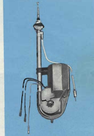
Antenna elettrica automatica Fissaggio: su carrozzeria Sezioni: 4 Lunghezza stilo: 970 Parte da incassare: 310 Lunghezza cavo: 1.150 Dotazione: interruttore Inclinazione: 0°÷43° Alimentazione: 12 V KT/2075-00
