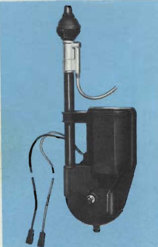
Antenna elettrica semi-automatica Fissaggio: su carrozzeria Sezioni: 4 Lunghezza stilo: 970 Parte da incassare: 310 Lunghezza cavo: 1.150 Dotazione: interruttore Inclinazione: 0°÷43° Alimentazione: 12 V KT/2080-00
