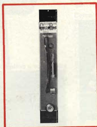
Antenna 27 MHz Elemento irradiante e molla in acciaio inossidabile Regolazione per ottenere il minimo di R.O.S. Carico induttivo alla base Potenza max applicabile: 50 W RF Impedenza: 50 Ω Altezza totale: 1200 m NT/0922 20
