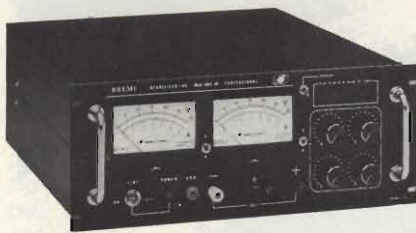
Alimentatore stabilizzato con possibilità di 2 uscite indipendenti.
