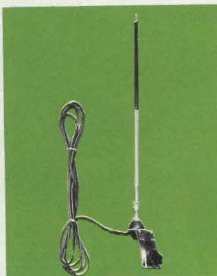
Antenna 27 MHz Fissaggio: carrozzeria Inclinazione: variabile Elemento ricevente: stilo in fibra di vetro con stub Lunghezza totale: 1300 R.O.S.: 1:1-1:1.2 NT/0928-01
