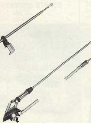
Antenna per autoradio Mod. BSA/21 Fissaggio: su carrozzeria Lunghezza cavo: 2.100 Sezioni: 2 Lunghezza totale: 840 Inclinazione: 0°÷90° KT/1170-00
