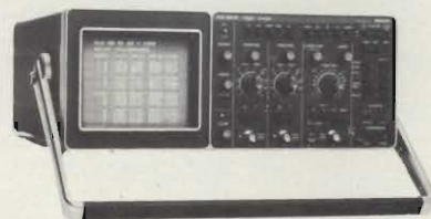
Combinazione di oscilloscopio e logic analyzer in un solo strumento.
